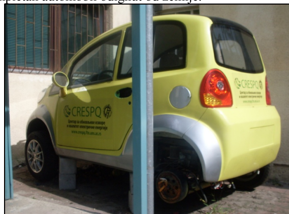
Sl. 21. Ispitivanje CRESQ-EA2 u praznom hodu.
