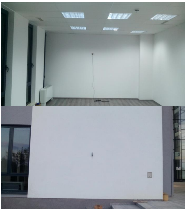
Sl. 3. a) položaj U-senzora unutar prostorije i b) položaj bežičnog temperaturnog senzora na sjeverozapadnoj fasadi
