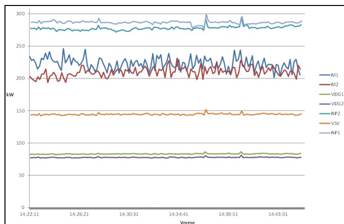
Sl. 2. Rezultati merenja aktivne snage elektromotora na kotlu 2 u nominalnom režimu rada
