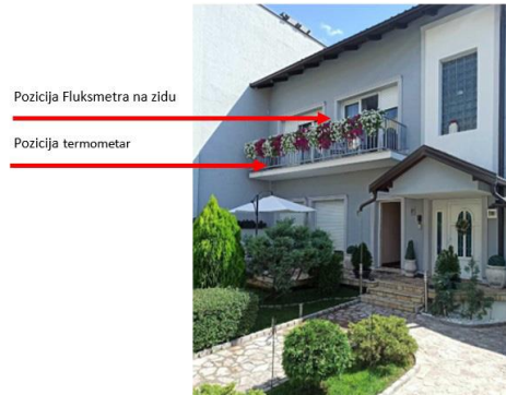
Sl. 5. Prikaz pozicije mjernih uređaja termometar (gore lijevo), fluksmetar, (gore desno) i pozicija na omotaču (dolje)
